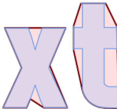
中間点を挿入したマルチポリゴンの外側の凹包による簡略化
